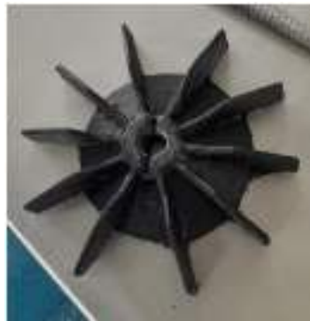
Fig. 5. Producto obtenido de Ingeniería Inversa de pieza automotriz aplicando escaneo 3D, sistemas CAD/CAM y Manufactura Aditiva
