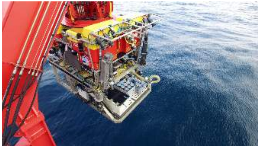
Figura 9 ROV 'ISIS', capaz de sumergirse hasta los 6500 metros [2].
