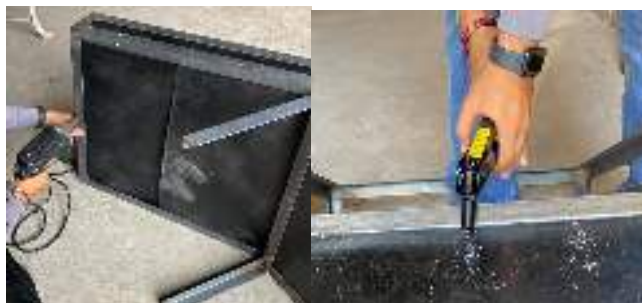
Figura 31. Taladrado y remachado del armazón completo
