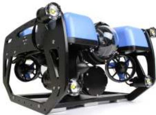
Figura 10 Robot submarino tipo BlueROV2 de BlueRobotics.
