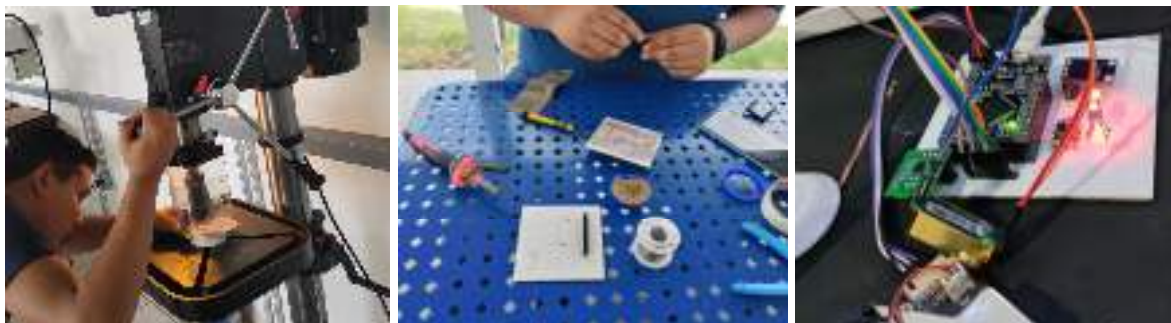
Figura 24. Perforación de la PCB e integración de los elementos del sistema mediante soldadura.
