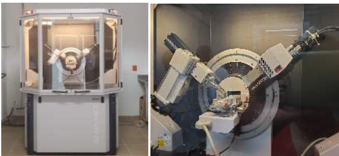
Fig. 3. difractómetro de rayos X D8 Advance marca Bruker. Laboratorio de Nanotecnología de la UAQ campus aeropuerto.
