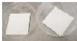
Figura 2. Distribución de la pasta de TiO_2 i sobre la placa de cristal
