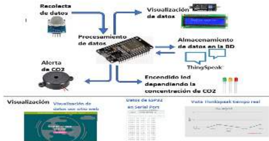
Fig. 3. Esquema de integración de herramientas de hardware y software de Sistema Tecnológico Aplicado de detección de CO2.
