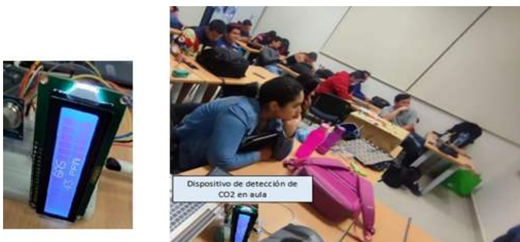
Fig. 4. Sistema Tecnológico Aplicado de detección de CO 2 en aula.
