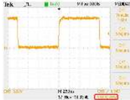
Fig. 4. Conmutación Drenaje-Fuente MOSFET IRF730.
