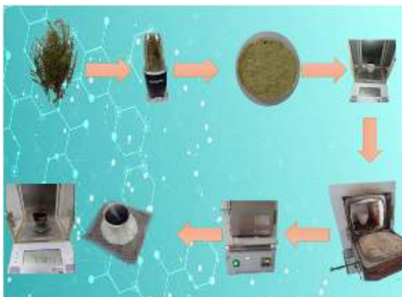
Fig. 1. Proceso para producción de grafeno por tratamiento térmico.
