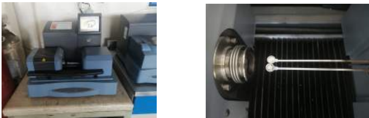
Fig. 1. a) Maquina de análisis TGA Y DTA, b) Balanza de precisión.
