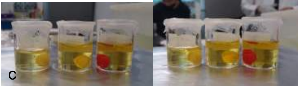
Fig. 2. (a) Biosíntesis de Ag NPs con extracto 751-749 LB a concentraciones 1:1, 1:2 y 1:5. (b) Biosíntesis de Ag NPs con extracto 751-745 MH a concentraciones 1:1, 1:2 y 1:5 y (c) Biosíntesis de Cu NPs con extracto 751-749 LB a concentraciones 1:1, 1:2 y 1:5
