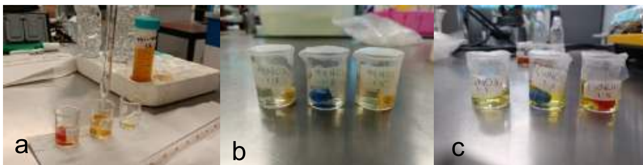
Fig. 1. (a) Extracto 751-749 LB en concentraciones 1:1, 1:2 y 1:5 en \text{AgNO}_3 , (b) Extracto 751-745 MH en concentraciones 1:1, 1:2 y 1:5 en \text{AgNO}_3 y (c) Extracto 751-749 LB en concentraciones 1:1, 1:2 y 1:5 en \text{Cu}(\text{NO}_3)_2
