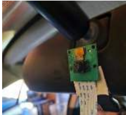
Ilustración 7: Instalación de la cámara en retrovisor.
