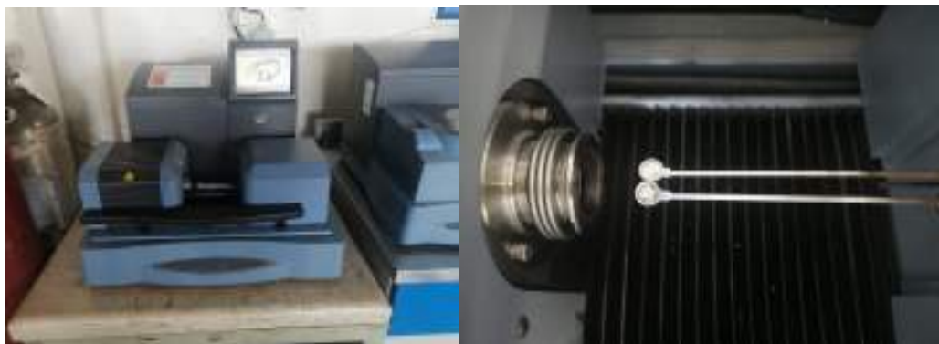
Fig. 1. a) Maquina de análisis TGA Y DTA, b) Balanza de precisión.
