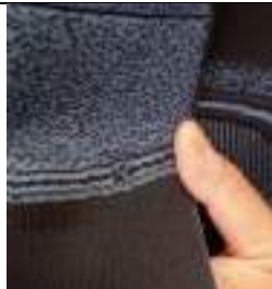
Imagen 1 Defecto de Remallado
