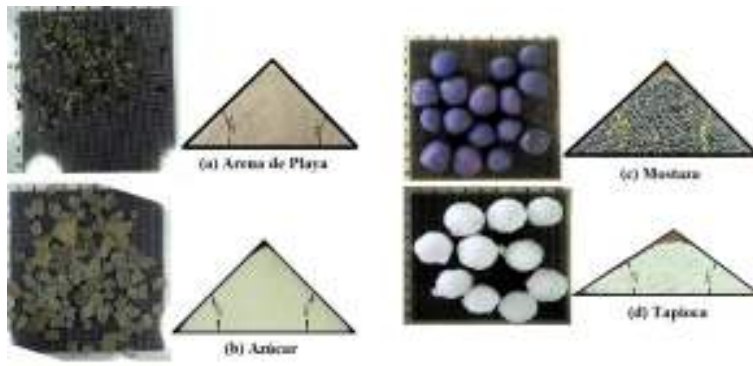
Fig. 4. Micrografía y ángulo de reposo del material granular.
