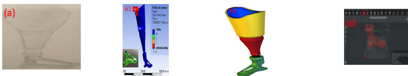
Fig. 2. (a) Dibujo a mano alzada del diseño propuesto; (b) Modelo 3D de la prótesis transtibial; (c) Factor de seguridad obtenido en la simulación de elemento finito; (d) Vista de interfaz de la impresora 3D con el pie de la prótesis.
