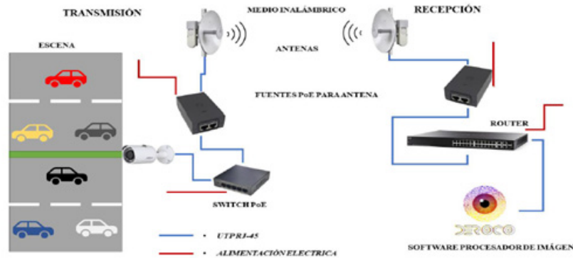
Fig. 4. Sistema de detección de tráfico vehicular.
