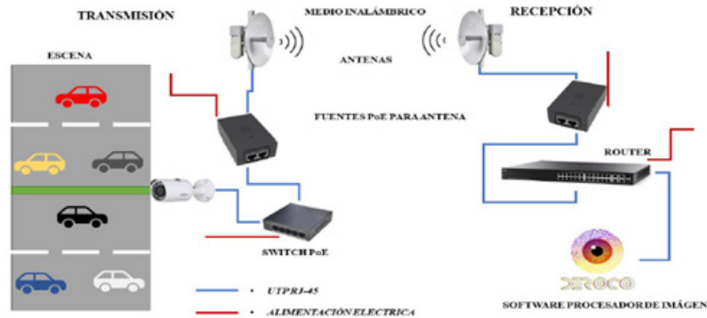
Fig. 4. Sistema de detección de tráfico vehicular.
