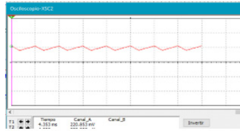
Fig. 7 Voltaje Fuente 24 volts (Azul) y voltaje a la salida (Rojo) 23 volts. Eje Y 20 volts/Div
