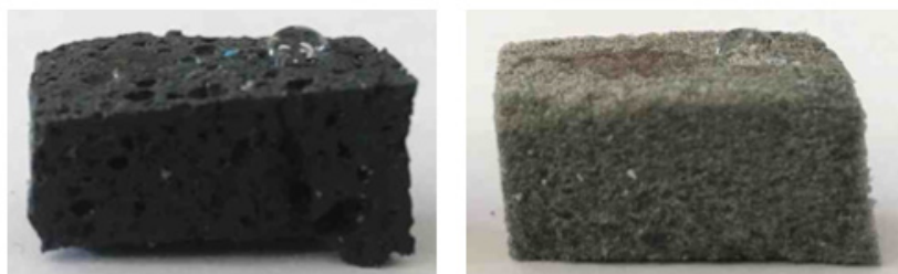
Fig. 4 a) esponja magnética de silicón/ Fe_3O_4 con propiedades hidrofóbicas y oleofilicas sobre la esponja magnética b) esponja de poliuretano con nanopartículas de Fe_3O_4 con propiedades hidrofóbicas y oleofilicas.
