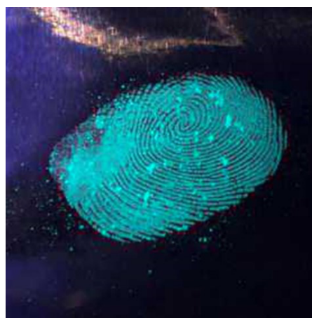
Fig. 2. Revelado de una huella dactilar sobre papel aluminio con SrAl 2 O 4 : Eu+2, bajo la irradiación de luz UV.
