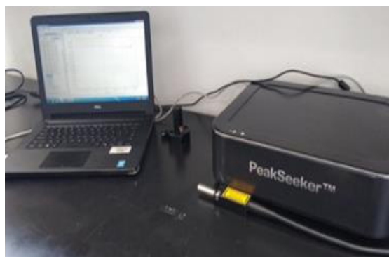
Fig. 2. a) Equipo Raman portátil. b) Toma de espectros Raman.
