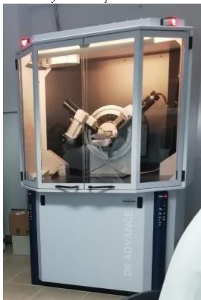
Fig 2. Difractor de Rayos X usado para la caracterización de la HAp
