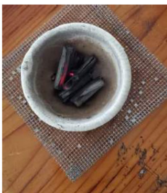
Fig. 2. Fotografía del proceso de enfriamiento de la muestra con un TT a 400°C (a); imagen representativa del proceso de pesado después del TT de la misma muestra (b).
