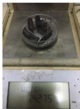
Fig. 2. Fotografía del proceso de enfriamiento de la muestra con un TT a 400°C (a); imagen representativa del proceso de pesado después del TT de la misma muestra (b).
